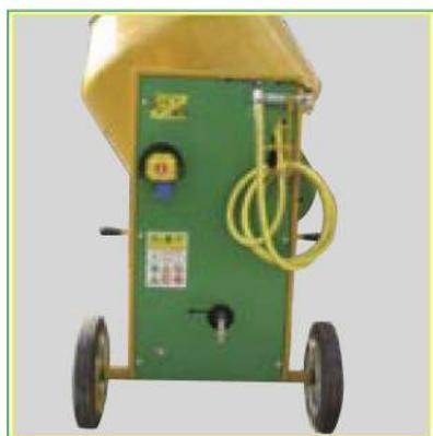
L'impianto idrico è posto sul retro della betoniera ed è dotato di un tubo di gomma (4 mt. ca. di lunghezza) con pistola a spruzzo incorporata.
